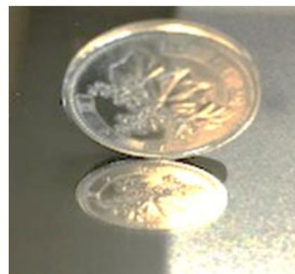
超硬工具の鏡面加工例
