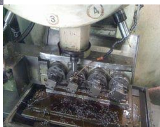
小型マシニングセンター 4連インデックス 加工で生産性を 高めています
