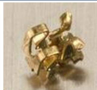
超小型電源端子: C1720-H t=0.12 要求精度 0.003
