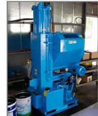
切屑は自動圧縮機で圧縮・固形化
