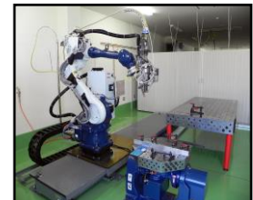
ディスクレーザ 5kw による高精度 な精密溶接で低歪みな溶接加工
