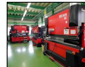
2.5m の直尺製品にも対応 するベンダーにて曲げ加工
