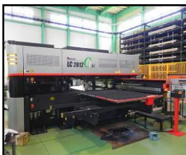
高度なパンチ・レーザ 複合機でブランク加工
