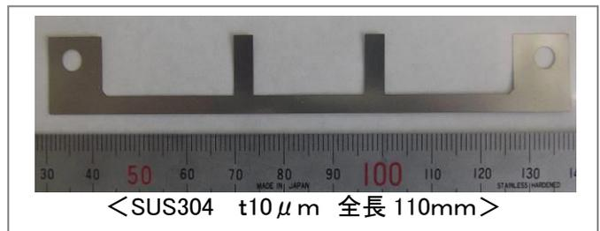
◆微細板金加工:全長数mmの薄物製作品を切削加工から微細精密板金・プレスへ切り替え
