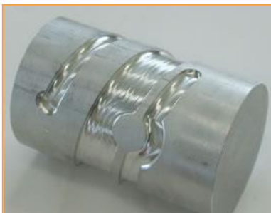
円筒側面加工 材質 AL5052
