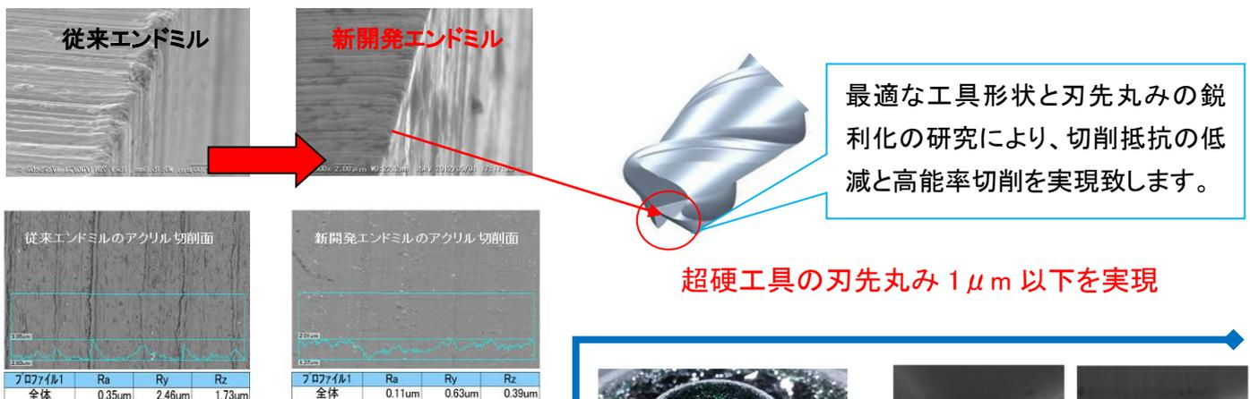
切削加工による加工面の変質(歪み)は製品寿命に深く関係します。航空機部品などの安全性向上には加工変質を極力小さくすることが重要です。
