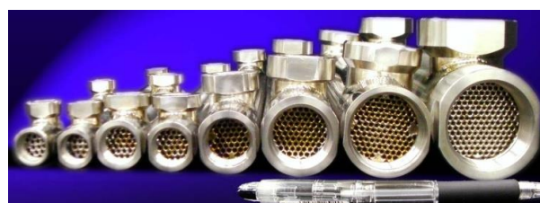
Φ60 中に ID φ2 x t0.3 パイプを 223 本-TIG 溶接(上記右端)
