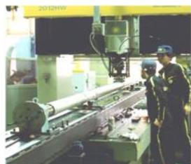
＜化学プラント用熱交換パイプへの 放熱フィン縫付溶接＞
