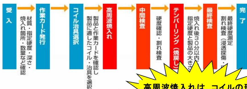
高周波焼入れは、コイルの形状で焼きが変化します。コイルを自社で設計、試作を行い詳細ニーズに対応しています
