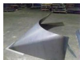
【写真左は SS 材 9 ミリ長さ 3350 mm の長尺曲げサンプル、右は SS 材 4.5 mm R 曲げ(角丸管)加工サンプルです】
