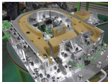
製造例 2 : 受部 Urethane 溶着治具
