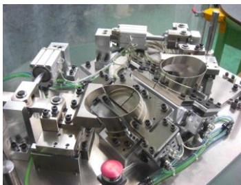
製造例 1 : 受部 Steel 溶着治具
