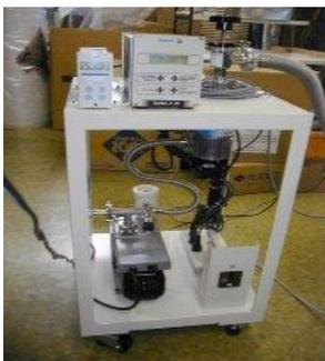
常温での実績の到達：  $1.8 \times 10^{-5}$  Pa (15h) まで超高真空を確認してます。
