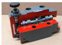
油圧バルブはボディとステムの高い精度が要求されます。
