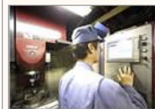
弊社のマシニングセンターは06年8月NC傾斜テーブルを導入し、高性能な加工も迅速にこなせるようになりました。NC旋盤加工後の追加加工を得意とし、幅広く「複合加工」に使用しております。
