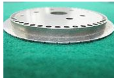
丸物製品の微細穴加工 微細穴と太穴は内部で連結
