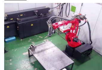
設備:YAG レーザ溶接機
