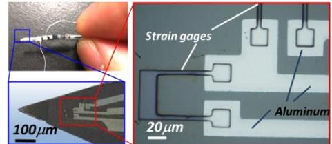
図3 細胞操作用ロボットハンド
