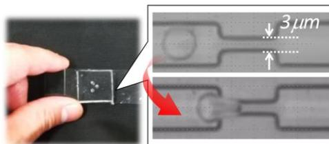
図2 人工毛細血管開発&赤血球硬さ計測
