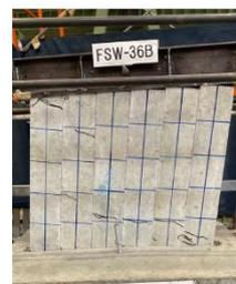
水平載荷実験状況
