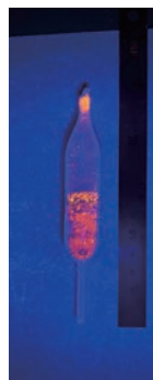
垂直ブリッジマン法によって育成した赤色発光ヨウ化物結晶
