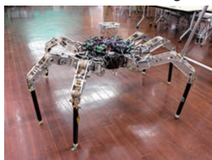
開発した 6 脚歩行ロボットの実験機 (脚長：1.4m、重量：65kgf)
