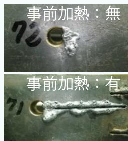
※) 配管裏側はレーザー光が広がることで切断されません
