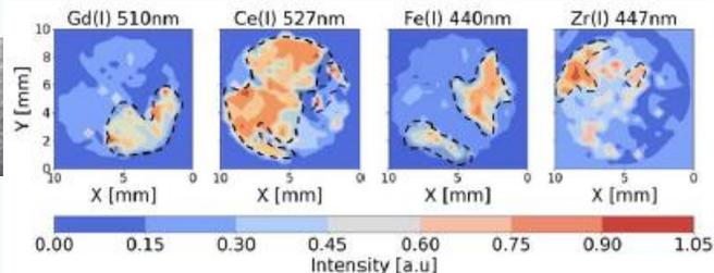
Gd, Ce, Fe, Zr 4元素複合試料（左写真）と各元素分布結果
