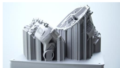
図1 ポルシェは電動ドライブのハウジングを3D プリントで作製
